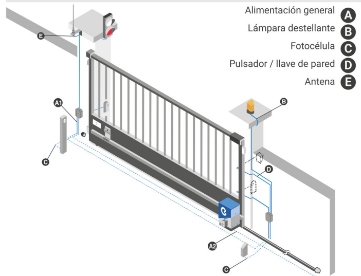
MOTOR +CUADRO MOTOR CUADRO RECEPTOR EMISOR FOTOCÉLULA CREMALLERA
